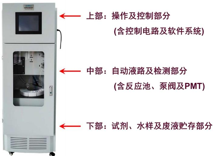
图 3-9 仪器整体结构
