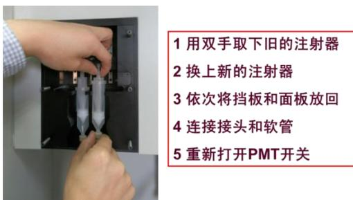
图 6-4 更换注射器
