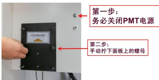
图 6-1 PMT 电源(光检测器电源)开关位置
