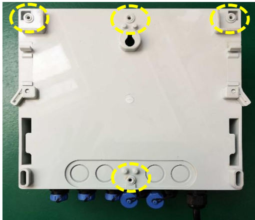
图 2-2 控制器背面自攻螺钉孔(4 个)
