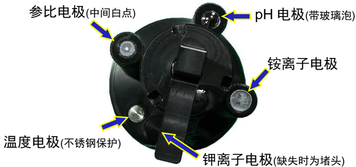
图 1-3 氨氮探头内部电极名称及位置
