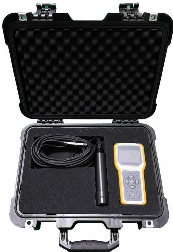
图 1-1 系列便携式水质分析检测箱内部图
